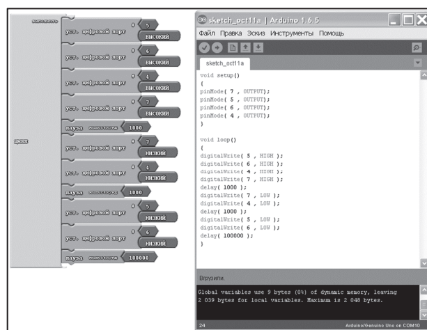
Рис. 3 Пример программы для робоплатформы в ArduBlock и соответствующий код Arduino.
