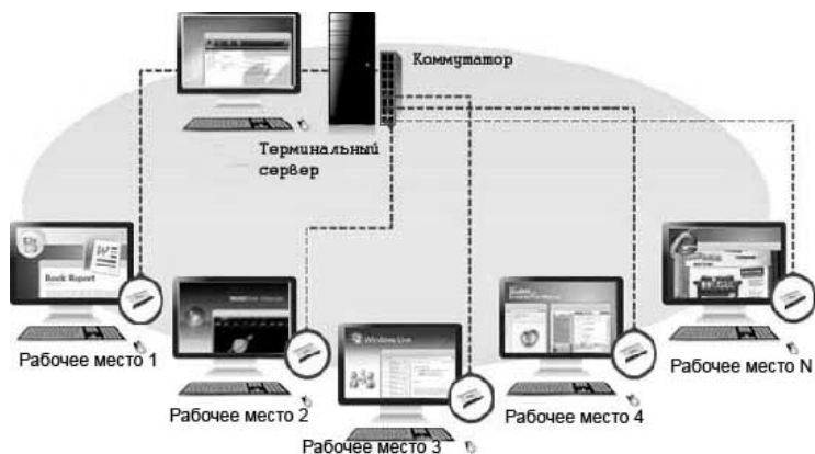
Рис. 2. Структура компьютерного класса с использованием «тонких клиентов»
